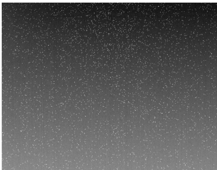
“Imagem” do ruído térmico ( dark current ) (mediana de 5 imagens de 150 s). Valor médio de 177, em 65536 níveis. Valor mínimo de 8, valor máximo de 9372. (imagem já corrigida do mapa de offset )
