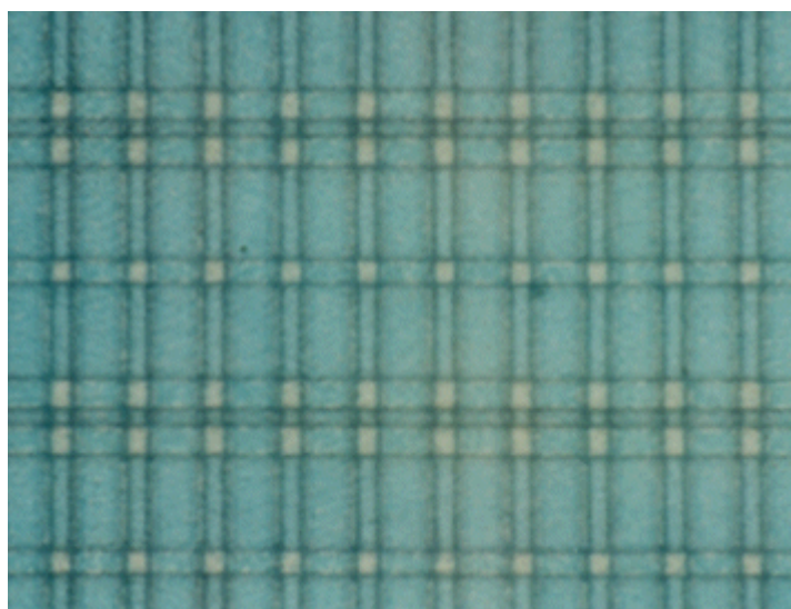
Fotografia da área sensível de um CCD, onde se podem ver os pixeis ordenados em linhas e colunas, de forma matricial.
