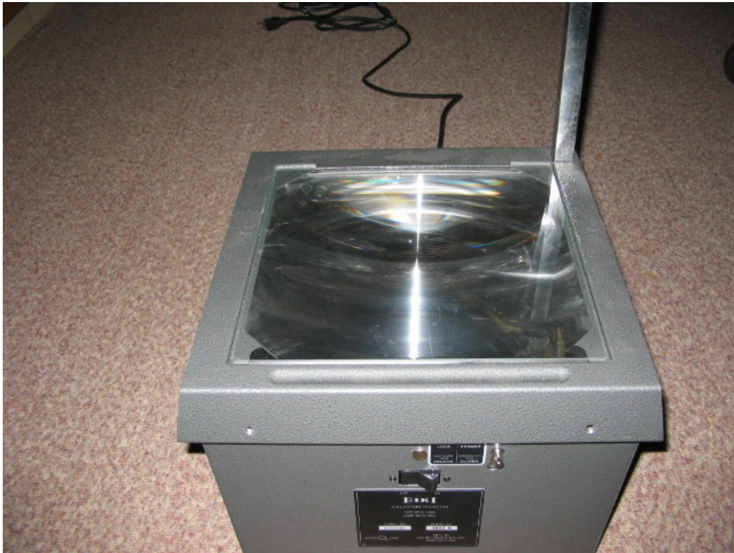
Retroprojector de acetatos. Lente colimadora de Fresnel f/0,5 .
