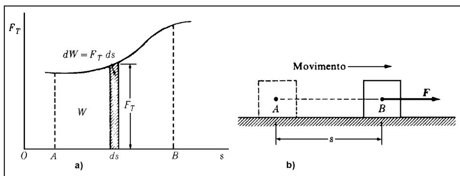
Figura 4.4 – a) Representação da força versus deslocamento.
