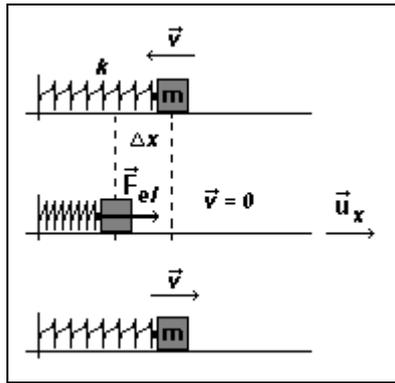
Figura 4.9 – Força elástica de uma mola de constante elástica  $k$ , comprimida de  $\Delta x$ .
