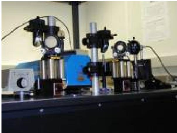
Figura 1.3 – Sistema actualmente usado na realização prática da definição do metro.
