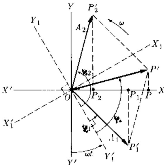
Figura 7.7 - Composição de dois MHS de igual frequência e direcção de vibração.
