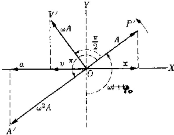
Figura 7.3 - Representação simultânea dos vectores girantes para o deslocamento ( $x$ ), velocidade ( $v$ ) e aceleração ( $a$ ) no M.H.S..
