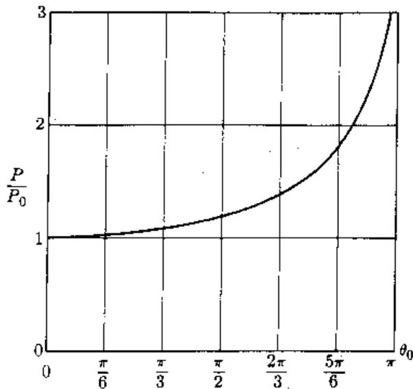
Figura 7.6 - Variação do período de um pêndulo com a amplitude de oscilação.
