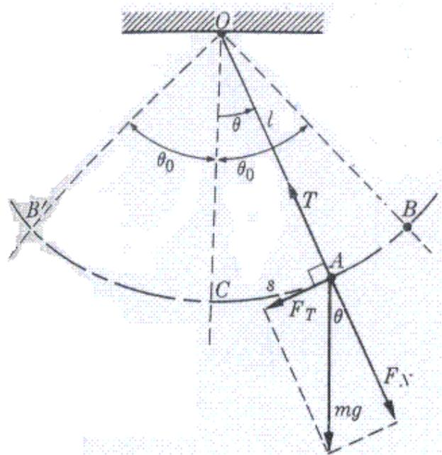
Figura 7.5 - Movimento oscilatório de um pêndulo.
