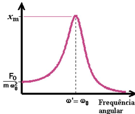
Figura 7.16 – Oscilador forçado com atrito – frequência de ressonância.
