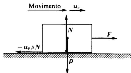
Figura 4.8 – Força de atrito na base de contacto entre um bloco e uma superfície.
