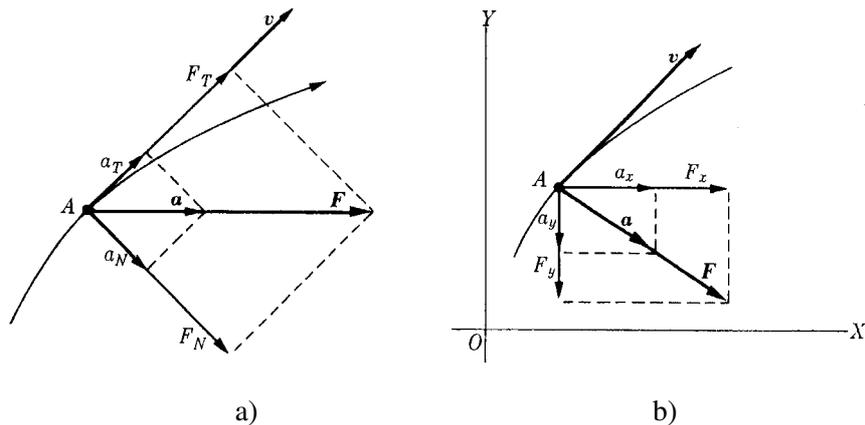
Figura 4.10 – Forças num movimento curvilíneo. a) Componentes tangencial e normal. b) Decomposição da força normal no sistema de eixos.
