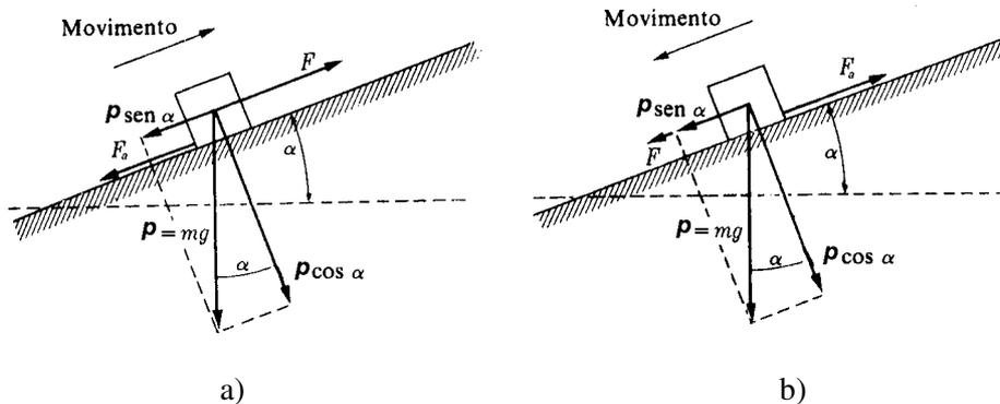
Figura 4.9 – Bloco de massa  $m$ . a) Forças aplicadas na subida do bloco. b) Forças aplicadas na descida do bloco.
