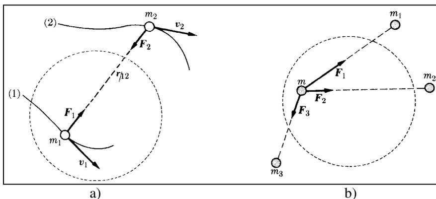
Figura 4.6 – a) Par acção-reacção. b) Força resultante sobre uma partícula.
