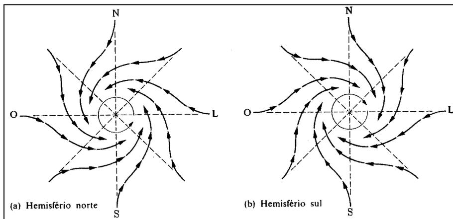
Figura 3.22 – Efeito do termo de *Coriolis* na rotação das massas de ar atmosféricas (em ambos os hemisférios).
