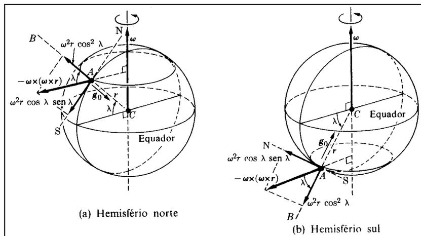
Figura 3.20 – Componente vertical e horizontal do termo centrífugo.
