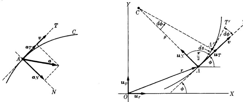
Figura 3.11 – Componentes da aceleração no movimento curvilíneo.
