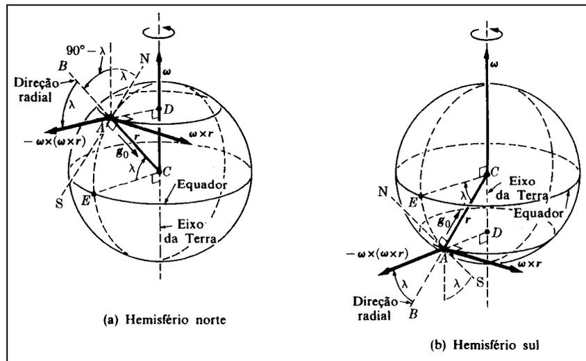
Figura 3.18 – Aceleração centrífuga devido à rotação da Terra.
