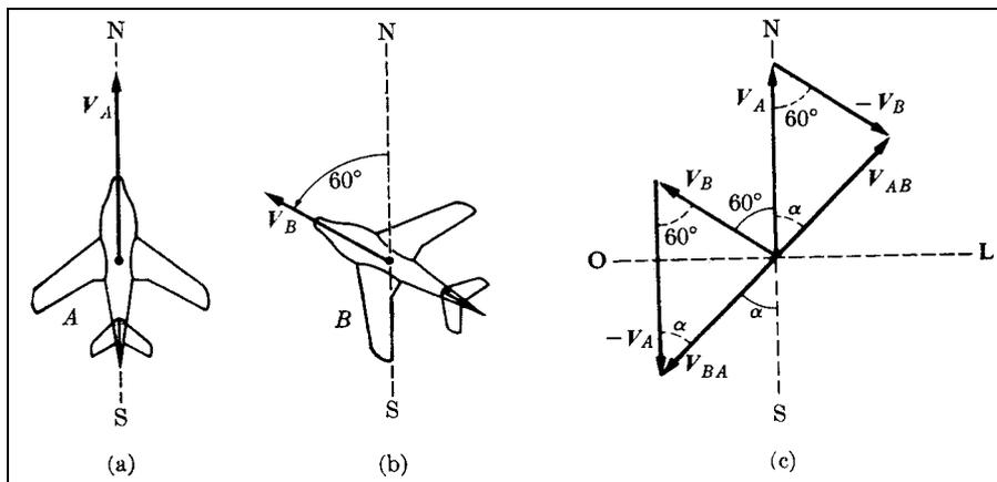
Figura 3.15 – a) Avião A, a voar no sentido norte. b) Avião B, a voar no sentido N60W. c) Representação dos vectores velocidade relativa.
