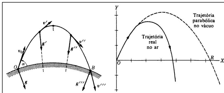
Figura 3.12 – Trajetória parabólica de um projectil, perto da superfície da Terra. Efeito da direcção da aceleração da gravidade e efeito da atmosfera (atrito do ar).
