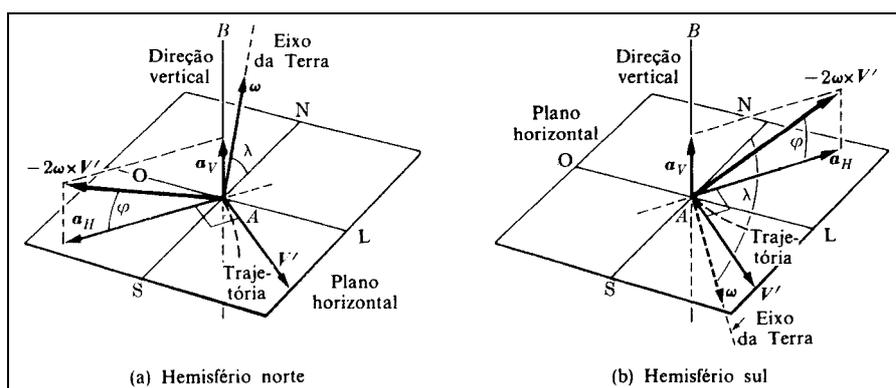
Figura 3.23 – Componente vertical e horizontal do termo de *Coriolis*, (em. ambos os hemisférios).
