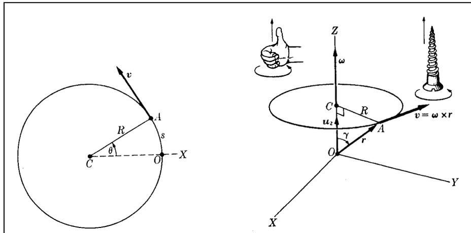
Figura 3.13 – Trajectória circular, velocidades tangencial e angular.
