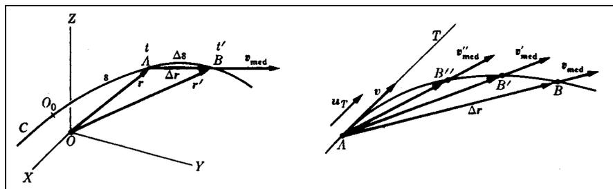
Figura 3.7 – Representação de uma trajetória curvilínea  $C$ .
