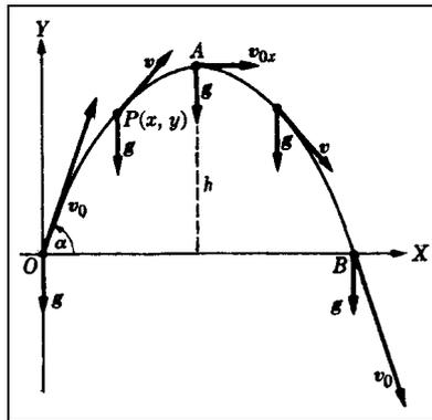
Figura 3.9 – Representação de uma trajetória curvilínea a duas dimensões.
