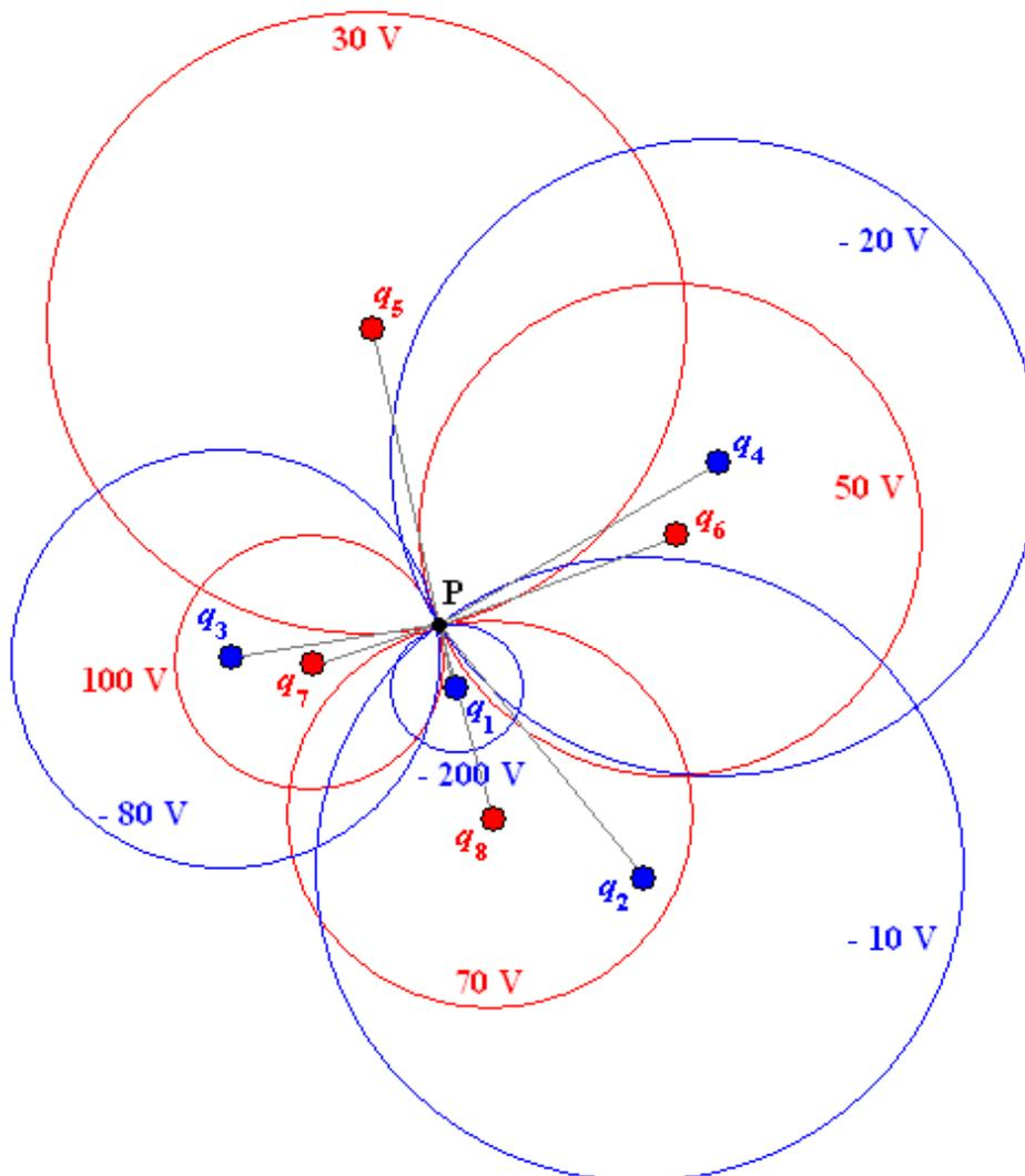
Figura 4.4 – Efeito (potencial eléctrico) de cargas eléctricas pontuais num ponto P do espaço.
