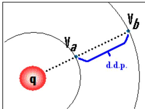
Figura 4.6 – d.d.p. entre dois pontos a e b, originada por uma carga pontual q.
