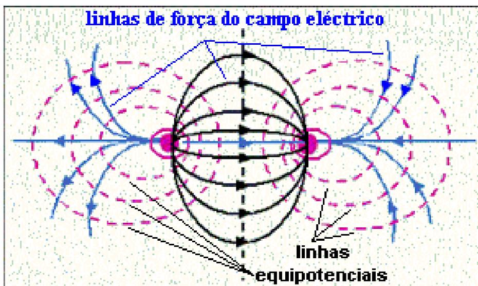
Figura 4.7 – Representação (no plano) de linhas equipotenciais e do campo eléctrico, originadas por um dipolo de carga eléctrica.
