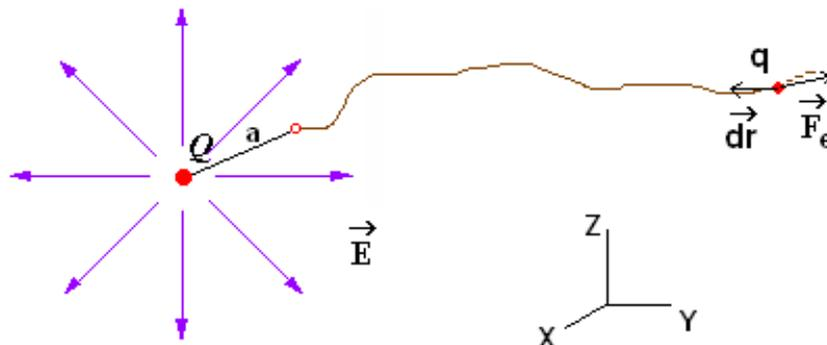
Figura 4.1 – Trajectória de uma carga pontual positiva  $q$ , sob a acção de um campo eléctrico.
