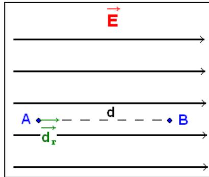
Figura 4.10 – d.d.p. ao longo de uma linha do campo eléctrico.
