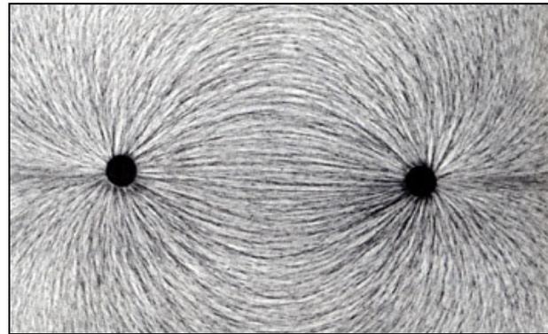
Figura 2.7 – Materialização das linhas de forças eléctricas (no plano) de um dipolo eléctrico.
