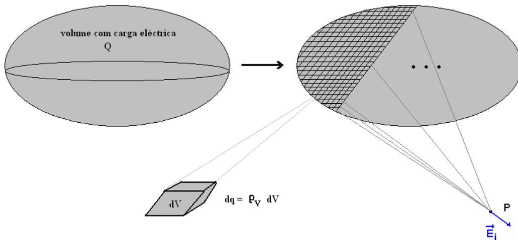
Figura 2.12 – Decomposição do volume inicial em domínios infinitesimais (pontuais) de carga eléctrica e efeito de cada um desses domínios, no ponto P.
