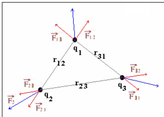
Figura 2.6 - Forças eléctricas de interacção (a vermelho) e as forças resultantes em cada carga (a azul).
