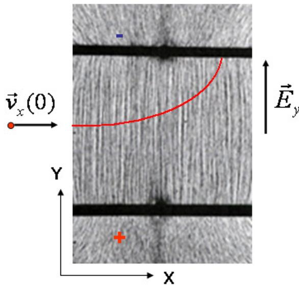
Figura 2.16 – Trajectória de uma carga eléctrica positiva.
